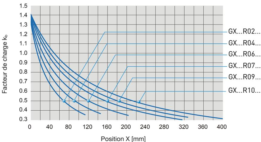
La charge radiale admissible peut être calculée en multipliant par le facteur de charge  $k_s$  donné sur le diagramme à gauche.
