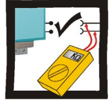
Débranchez l'appareil des circuits lorsque vous procédez à des contrôles d'isolation à tension élevée.
