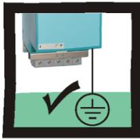
L'appareil doit être mis à terre en permanence en raison du fort courant de fuite à la terre.
