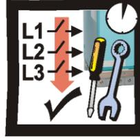
Avant de travailler sur l'appareil, coupez l'alimentation secteur au niveau des bornes L1, L2 et L3 et attendez 3 minutes.
