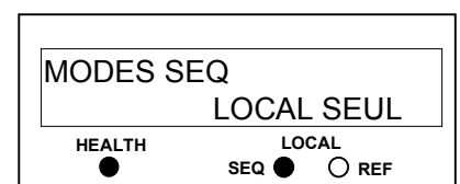
Figure 4- 3 Indications du mode de contrôle
